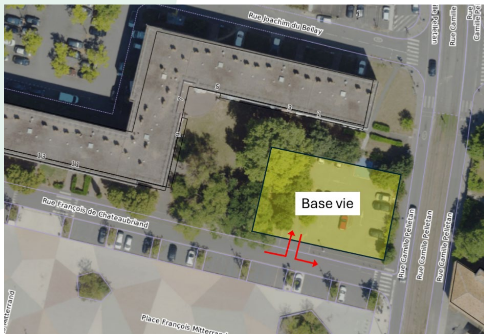
Emprise des installations de chantier pour la Base vie – Rue F. Chateaubriand
